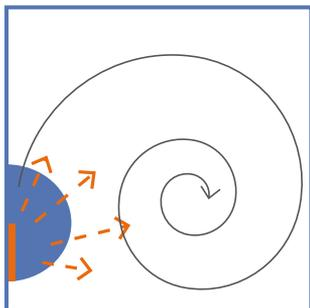
Heizkörper heizen nur den umliegenden Bereich auf. Der Raum wird vorrangig durch die zirkulierende Warmluft erwärmt. Im Raum befindlicher Staub, Hausstaubmilben und Bakterien werden permanent verwirbelt.
