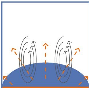
Fußbodenheizungen erwärmen die Raumluft im Fußbodenbereich. Die warme Luft steigt in Intervallen nach oben und zirkuliert. Auch hier werden Staub, Milben und Bakterien im Raum verteilt.
