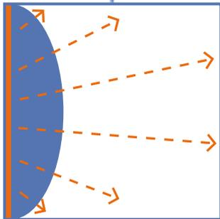
Wandheizungen gewährleisten ein gleichmäßiges Temperaturniveau innerhalb des beheizten Raumes. Die Wärmestrahlung wird von den umgebenen Wänden absorbiert und reflektiert.
