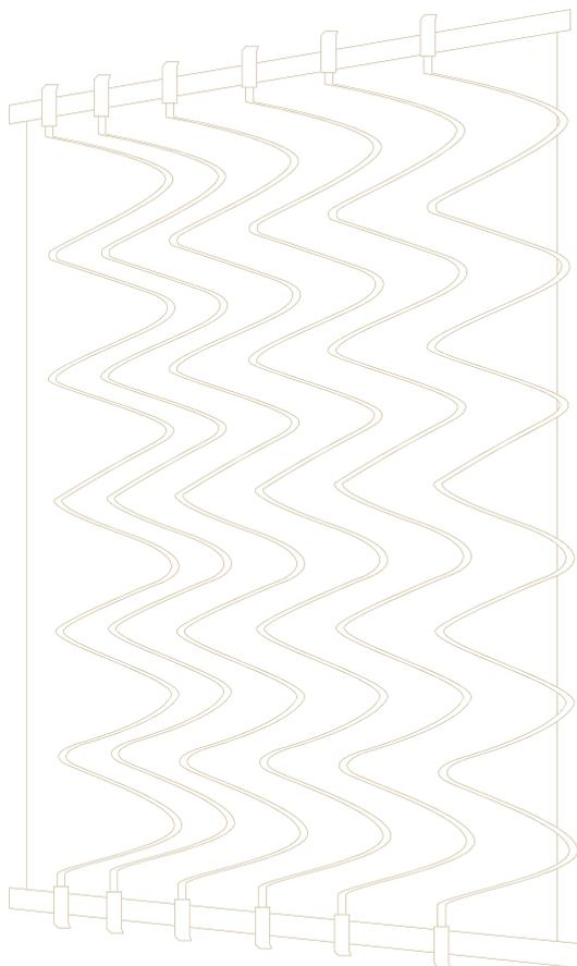
Komplett vorgefertigte Kupferrohrmodule unterschiedlicher Höhe und Breite werden auf den Wandflächen installiert und eingeputzt.
